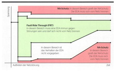
**Bild 1** Symbolische Darstellung des Zusammenspiels von Fault Ride Through (FRT) und dem NA-Schutz. Ist der NA-Schutz zu restriktiv eingestellt, hebelt er die Funktion des FRT aus.
