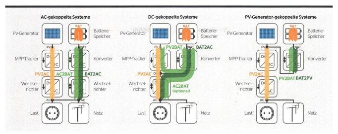
Bild 1 Systemtopologien von PV-Speichersystemen mit Energieumwandlungspfaden.
