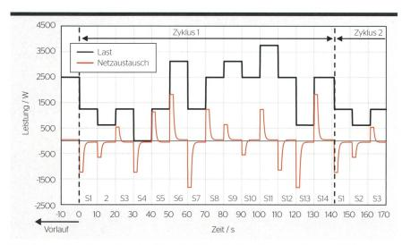
**Bild 4** Stufenprofil zur Charakterisierung der dynamischen Regelabweichung mit beispielhafter Visualisierung der Leistungsverläufe für ein System mit einer nominalen Lade- und Entladeleistung von 2500 W.
