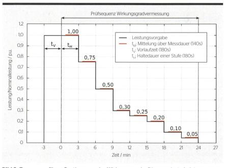
**Bild 3** Treppenprofil zur Bestimmung der Wirkungsgrade. Die normierte Leistung entspricht bei BAT2AC der Last, normiert auf die jeweilige Nominalleistung. Bei PV2BAT, AC2BAT, PV2AC entspricht sie der MPP-Leistung des PV-Simulators, normiert auf die jeweilige Nominalleistung.
