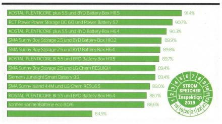
Bild 5 Ergebnisse der Stromspeicher-Inspektion 2019.
