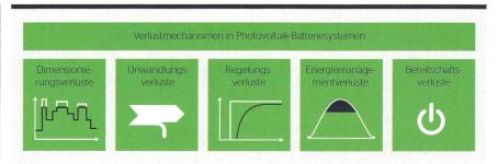
Bild 2 Überblick über die Verlustmechanismen von PV-Speichersystemen.
