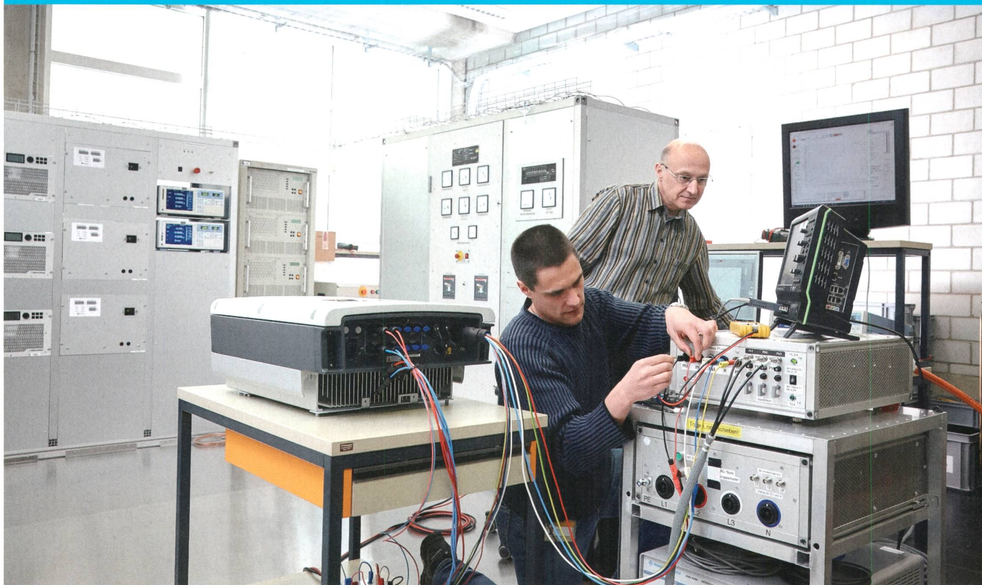
BFH-Prüflabor für PV-Wechselrichter und PV-Speichersysteme.
