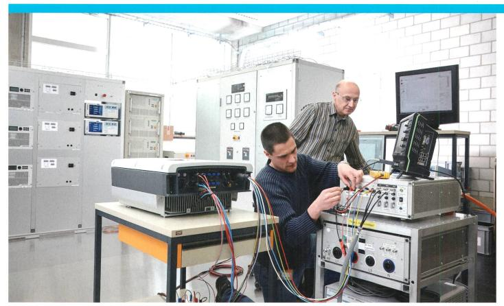
BFH-Prüflabor für PV-Wechselrichter und PV-Speichersysteme.
