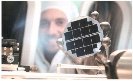
Dreifachsolarzellen aus dünnsten Schichten III-V-Halbleitern auf Silizium-Solarzellen.
