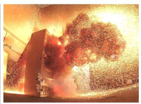
Störlichtbogenprüfung ohne Schutzmassnahmen.
