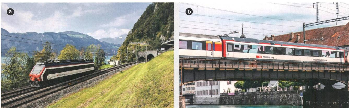
**Bild 2** a) Selbstfahrendes und b) gezogenes Diagnosefahrzeug.
