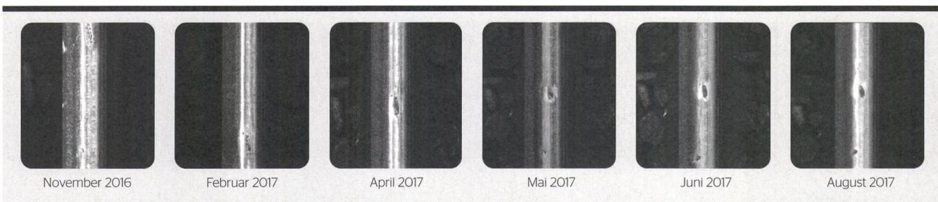
Bild 6 Zeitlicher Verlauf eines mit Fingerprinting gefundenen Fehlers.
