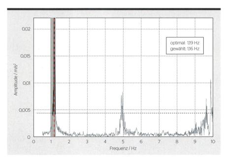
Materialunabhängige Eigenfrequenzmessung eines Mastsystems.
