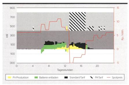
Bild 3 Lastdeckung nach Quelle.
