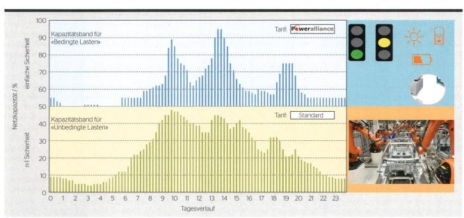
Bild 1 Bedingte und unbedingte Kapazitätsbänder in einer Netzengstelle.
