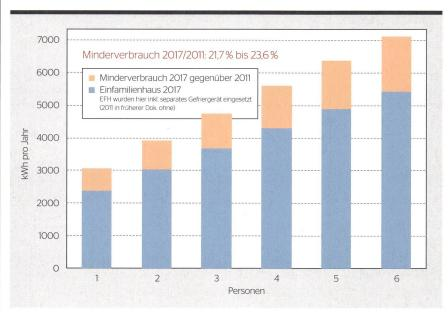
Bild 2 Typischer Haushalt-Stromverbrauch, Einfamilienhäuser, Vergleich mit 2011.
