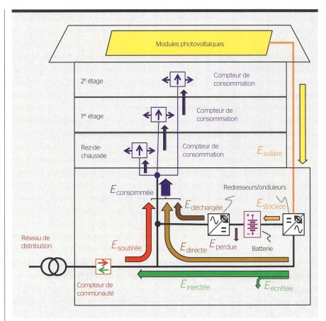
Figure 1 Communauté d'autoconsommation, flux et compteurs.
