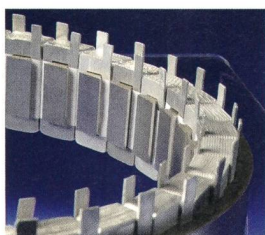
Aluspulen für luftgekühlten Radnabenmotor.
