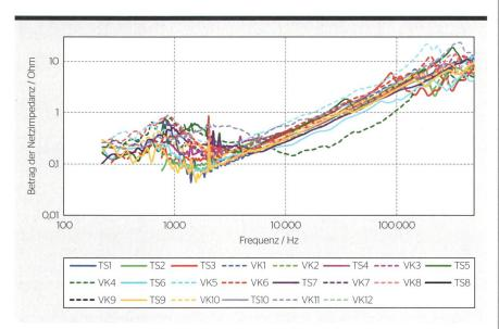
Bild 6 Ergebnisse der Netzimpedanzmessungen der HES-SO.
