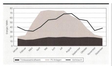
**Bild 3** Monatliche elektrische Energieerzeugung (Flächen) und monatlicher Energieverbrauch (Linie) im autarken Netzgebiet – Variante «autark».
