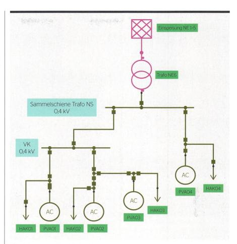
**Bild 2** Darstellung eines Teilnetzes
