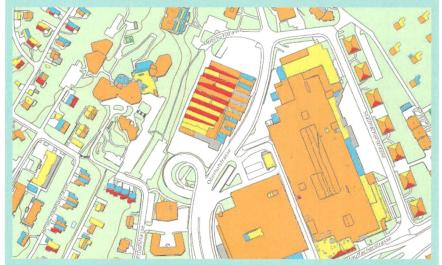
Auszug aus dem Solarkataster Luzern. Die Farben zeigen, wie gut sich ein Dach für eine PV-Installation eignet: rot = sehr gut geeignet (>1100 kWh/m² pro Jahr); orange = gut geeignet (950–1100 kWh/m² pro Jahr); gelb = mässig geeignet (800–949 kWh/m² pro Jahr); blau = schlecht geeignet (200–799 kWh/m² pro Jahr).
