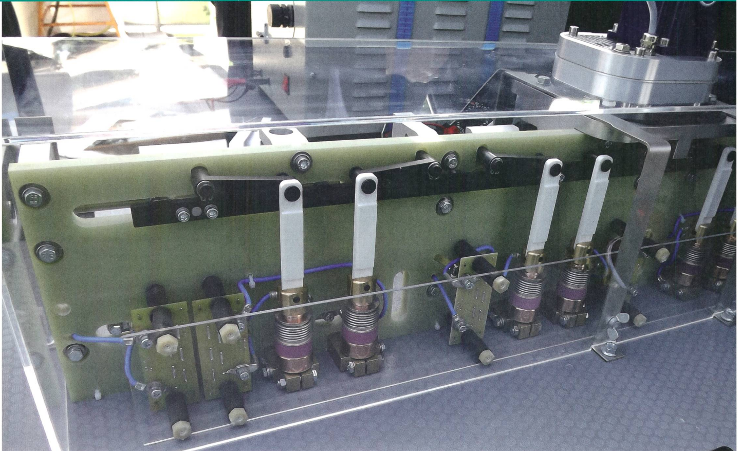
Schaltergruppe eines regelbaren Ortsnetztrafos der Maschinenfabrik Reinhausen.
