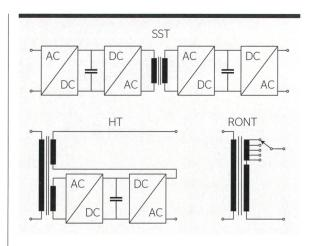
**Bild 1** Vereinfachte schematische Darstellung der untersuchten Transformatortechnologien.
