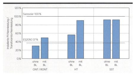
**Bild 3** Installierbare PV-Leistung in Netzebene 7 bis zur Verletzung des erlaubten Spannungsbandes bzw. bis zur Überlastung einer Leitung im Mittelspannungsnetz in Abhängigkeit der Blindleistungscharakteristik der PV-Wechselrichter (BL = Blindleistungsbereitstellung). Die PV-Zubauziele der ES2050 sowie «Swissolar» sind ebenfalls dargestellt.
