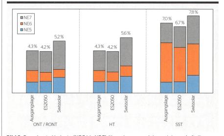
**Bild 2** Berechnete Verluste (NE 5 bis NE 7) über ein ganzes Jahr und deren Aufteilung auf die einzelnen Netzebenen. Die relativen Verlustangaben (in %) beziehen sich auf die gesamthaft umgesetzte Energie, die in den Zukunftsszenarien ansteigt.
