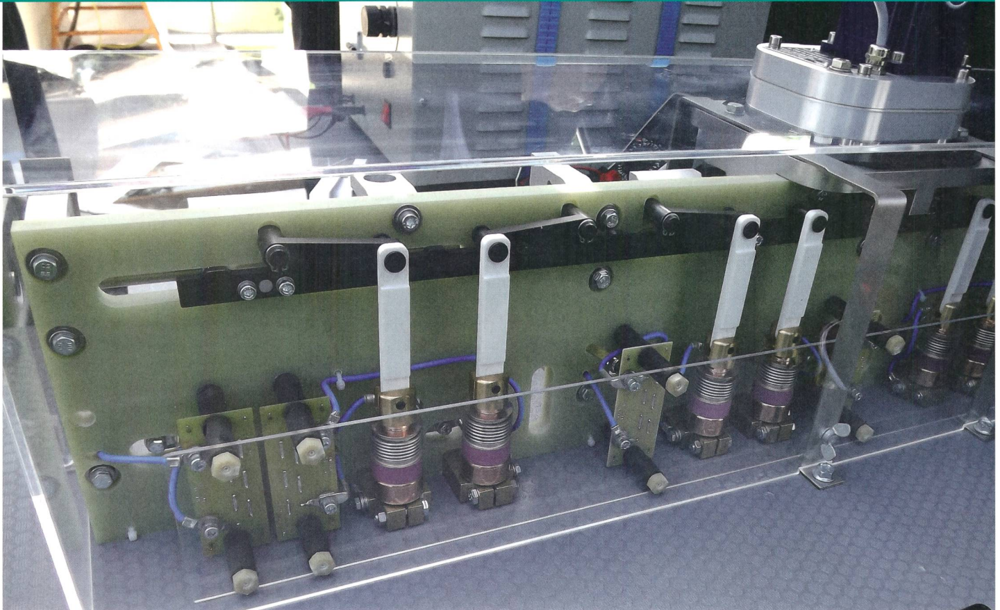
Schaltergruppe eines regelbaren Ortsnetztrafos der Maschinenfabrik Reinhausen.
