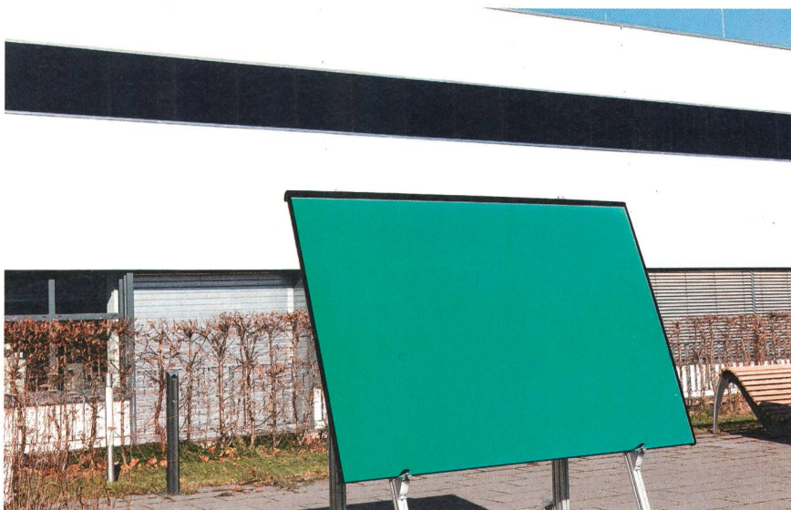
Die grünen PV-Module liefern 195 W - 93% der Leistung der schwarzen auf der Fassade.
