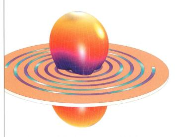
Visualisierung der log-skalierten Norm des elektrischen Feldes und des Fernfelds einer Spiralschlitzantenne. Drahtlose Kommunikation ist heute allgegenwärtig bei Übertragung, Erfassung und Zuordnung von Informationen. Oft setzt man dabei auf Spiralschlitzantennen, wegen ihres konsistenten Strahlungsmusters, ihrer Impedanz und der grossen Bandbreite. Zur Optimierung des Antennendesigns verwenden Ingenieure EM-Analysesoftware, zum Beispiel um S-Parameter und Fernfeldmuster zu berechnen.
