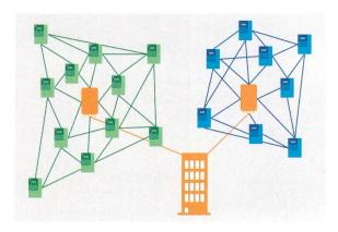
Zwei Maschennetze verbinden die Zähler (grün und blau); die Angaben werden von den Konzentratoren gesammelt und an die zentrale Datenbank der MDM-Software gesendet (gelb).
