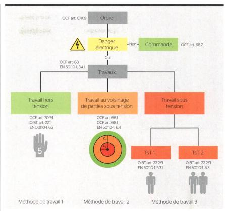
Figure 1 Déroulement d'une intervention en rapport avec l'électricité.
