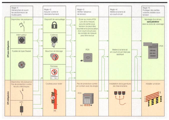
Figure 2 Règles de sécurité pour les électriciens.
