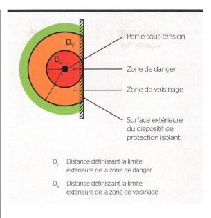
Figure 6 Zone de voisinage avec écran (méthode de travail 2). DL avec tensions alternatives < 1000 V: rayon autour de la partie sous tension 0 mm, Dv avec tensions alternatives < 1000 V: rayon autour de la partie sous tension 300 mm.
