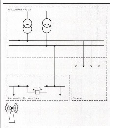
**Bild 1** Darstellung des Stromnetzes mit den beiden 40-MVA-Leistungstransformatoren, den zwei in die Kundenstation führenden Mittelspannungskabeln und der Sammelschienenkupplung im Detail.
