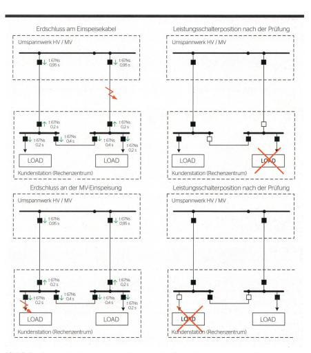
**Bild 6** Positionen der Leistungsschalter nach der Einspeisung von Erdschlüssen an unterschiedlichen Stellen.
