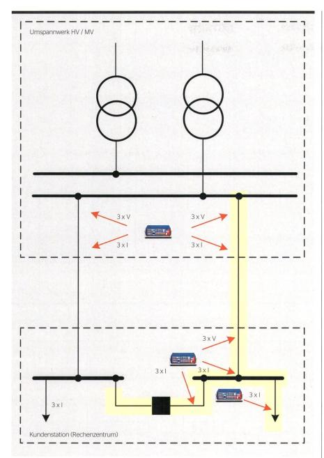
**Bild 4** Das Bild zeigt ein Beispiel der Strom- beziehungsweise Spannungseinspeisungen für die Prüfung des Schutzsystems mit einem CMC-Prüfgerät, gesteuert von RelaySimTest.
