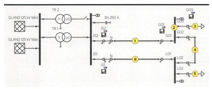
Bild 3 Mit dem Prüfplan wurden sechs Hauptprüffälle identifiziert, die hier im RelaySimTest-Netzmodell dargestellt sind.
