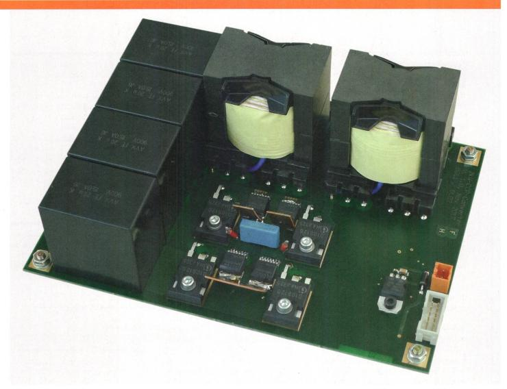
Prototyp eines bidirektionalen Borgna-Konverters mit 2 kW Nennleistung.
