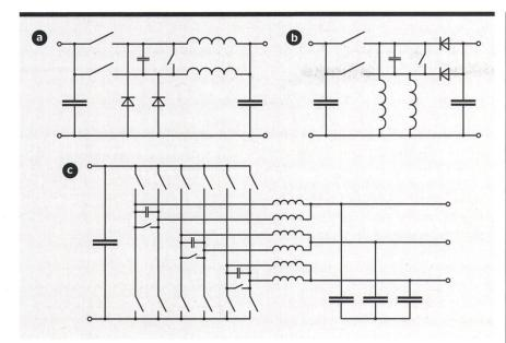
**Bild 3** Mögliche Topologien von Borgna-Konvertern (Auswahl). a) Abwärtswandler, b) Inverswandler, c) dreiphasiger Wechselrichter.
