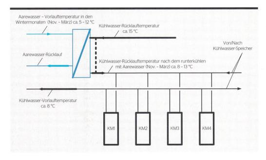
Schema der Aarewasserkühlung: Im Winter wird das Kühlwasser vor dem Eintritt in die Kältemaschinen mit Aarewasser vorgekühlt. Der Energieverbrauch wird damit um fast 25 % verringert.
