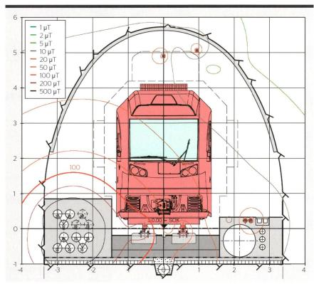
**Bild 7** Magnetisches Feld bei bestmöglicher Phasenanordnung, im ungünstigsten Fall der Stromrichtungen, sowie maximalem Strom.
