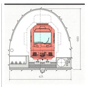
**Bild 3** System 1: Kabellegung in geschütztem Kanal.
