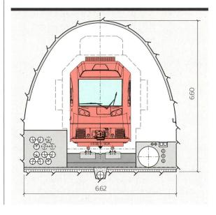
**Bild 4** System 2: Kabellegung im Rohrblock.
