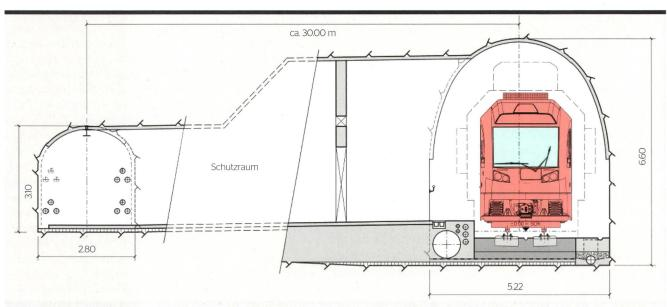
Bild 5 System 3: Kabellegung in separatem Tunnel.
