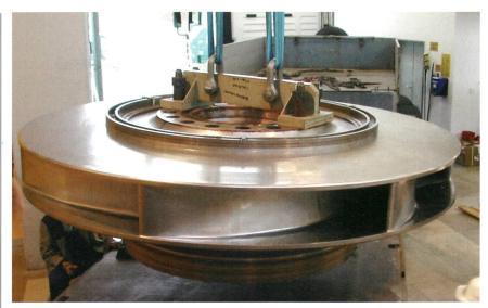
**Bild 1** Laufrad einer Francis-Pumpturbine, Aussendurchmesser 3,0 m, Betriebsdrehzahl 8,35 s<sup>-1</sup>, Durchfluss  $\leq$ 32 m<sup>3</sup>/s.
