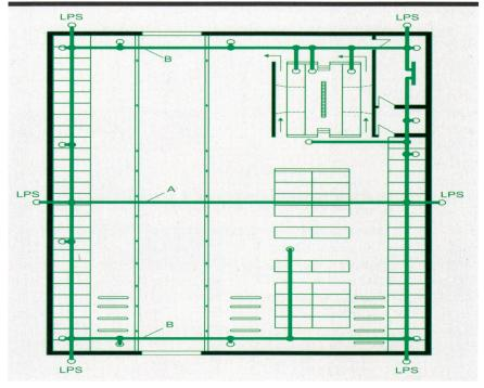
Erdungssystem in einem Stall. A: Verbindung bei Ställen, die über 15 m lang sind, B: ringförmig angeordneter Fundamenterder,
