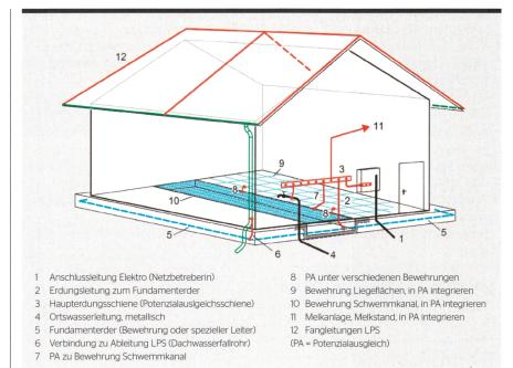
Komponenten eines Erdungssystems in einem Stall.
