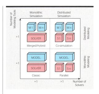
Figure 1 Différents types de simulations numériques.
