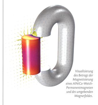
Ferromagnetische Teile beeinflussen das Magnetfeld in ihrer Umgebung. Beim Entwurf von elektronischen Komponenten und elektrischen Maschinen ist dies unbedingt zu beachten. Simulationen können Ihr Verständnis dafür vertiefen, wie magnetische Materialien die Gesamtleistung eines Geräts oder Systems beeinflussen. Ferromagnetische Materialien zeigen jedoch nicht alle das gleiche Verhalten. Für genaue Modelle benötigen Sie eine Software, die beschreiben kann, was in der realen Welt passiert.
