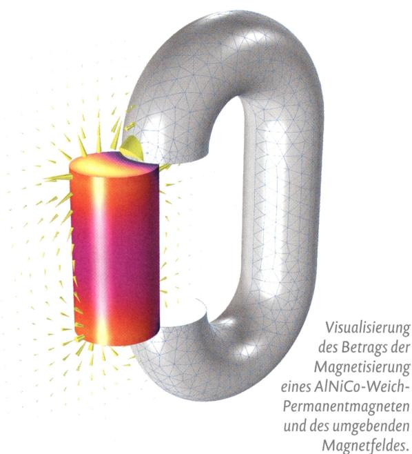
Ferromagnetische Teile beeinflussen das Magnetfeld in ihrer Umgebung. Beim Entwurf von elektronischen Komponenten und elektrischen Maschinen ist dies unbedingt zu beachten. Simulationen können Ihr Verständnis dafür vertiefen, wie magnetische Materialien die Gesamtleistung eines Geräts oder Systems beeinflussen. Ferromagnetische Materialien zeigen jedoch nicht alle das gleiche Verhalten. Für genaue Modelle benötigen Sie eine Software, die beschreiben kann, was in der realen Welt passiert.
