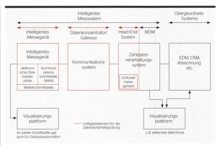
Die Komponenten eines intelligenten Messsystems.
