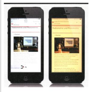
Figure 2 Lorsque la fonction « night shift » (éclairage nocturne) est activée (à droite), le spectre de la lumière varie au fil de la journée et l'éclairement mélanopique est réduit en conséquence.
