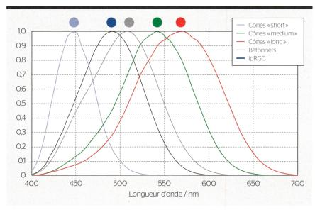
**Figure 1** Spectres d'action actiniques des cinq photorécepteurs différents de l'œil humain. Les cellules ganglionnaires photosensibles (ipRGC) possèdent un maximum de sensibilité dans la zone bleu cyan.
