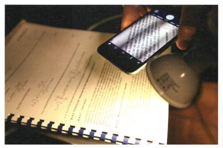
**Figure 3** Un smartphone permet de visualiser les effets du papillotement lorsque la quantité de lumière est suffisante et lorsque le temps d'intégration en résultant est assez court (« vitesse d'obturation électronique »).
