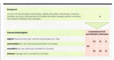
Bild 1 Ausschnitt aus Tabelle A.1 Entscheidungshilfe zur Festlegung von Prüfintervallen.
