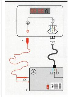
**Bild 3** Skizze D.4.3 zur Messung des Schutzleiterwiderstandes.
