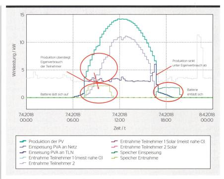
Bild 2 Beispiel eines typischen Tagesverlaufs eines einfachen ZEV.
