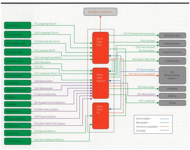
Bild 4 Übersicht über das System- und Schnittstellenkonzept.
