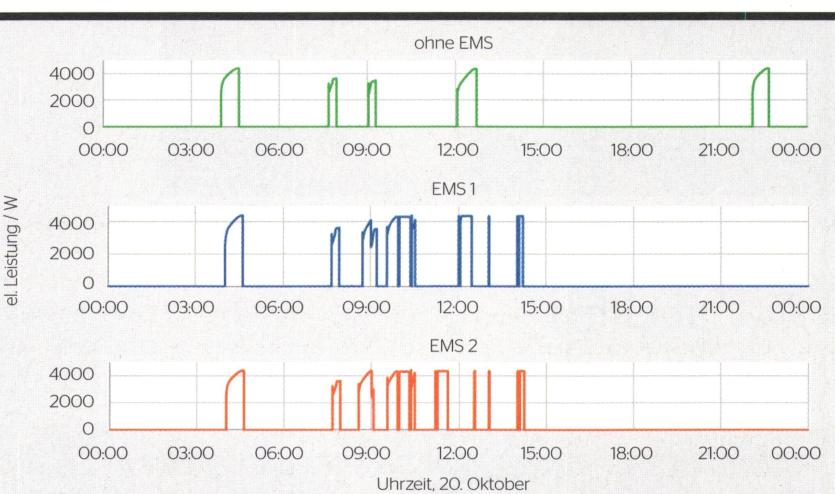
**Bild 4** Leistungsverbrauch der Wärmepumpe bei Betrieb ohne Steuerung und bei Steuerung durch zwei unterschiedliche EMS.
