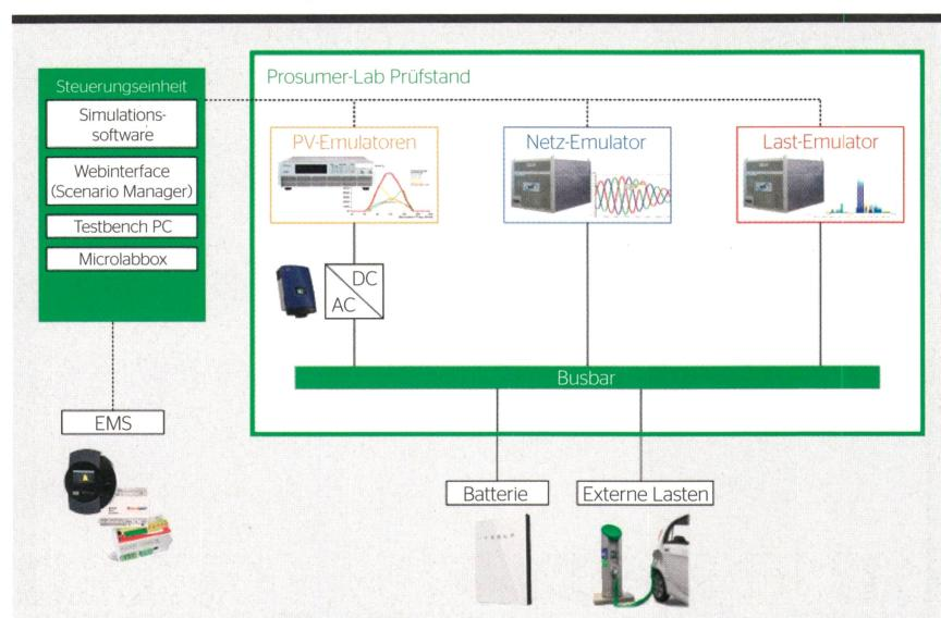
**Bild 1** Schema des Prosumer-Lab-Prüfstands.
