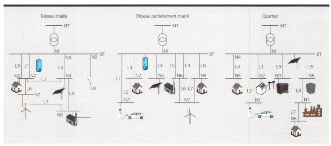
Figure 3 Exemples de topologies réalisables à l'aide des 9 lignes et du tableau de connexion.
