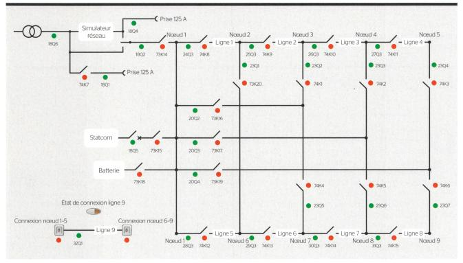
Figure 2 Synoptique des lignes du réseau.
