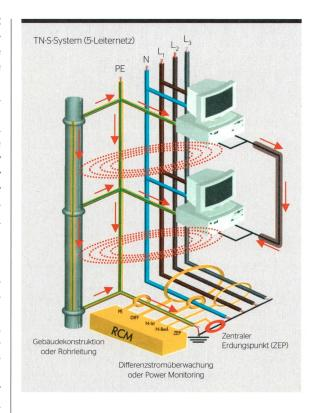
Bild 3 Das TN-S-System gilt zwar als EMV-günstig, aber bei einem parallel zu den Aussenleitern verlegten PE mit unterschiedlichen Abständen zu den Aussenleitern entstehen durch das Streufeld (rot) Erdschlaufenströme.
