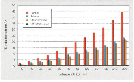
Bild 4 PE-Induktionsströme der Leiteranordnungen.
