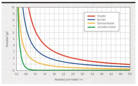
**Bild 2** Magnetische Streufelder bei  $I_1$ = 250 A,  $I_2$  = 216 A,  $I_3$  = 195 A,  $I_N$  = 48,1 A.
