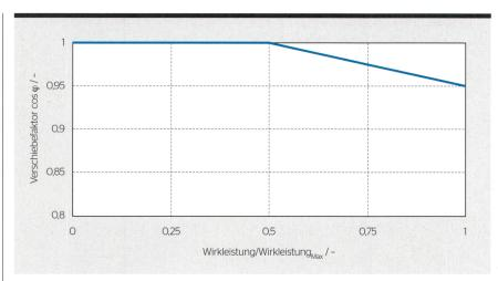
Bild 1 Kompensationskurve Deutscher Standard.
