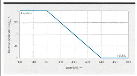
Bild 2 Kompensationskurve Blindleistung Hybrid-Ansatz.
