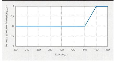
Bild 3 Kompensationskurve Wirkleistung Hybrid-Ansatz.
