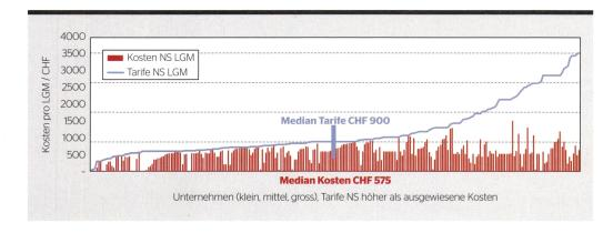
**Bild 7** Kosten und Tarife für Lastgangmessungen NS nach aArtikel 8 Absatz 5 StromVV.
