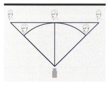
**Bild 2** Winkelabhängige Verzerrung von Bildbereichen ausserhalb der Sichtachse.
