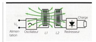
Principe du transfert d'énergie par induction en champ proche.
