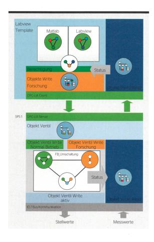
**Bild 5** Zugriffsarchitektur über Labview auf die Steuerung.
