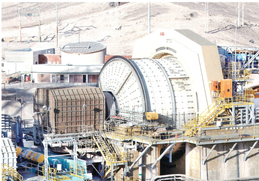
Un broyeur à minéral sans engrenage d'ABB : le CSEM utilise une telle installation dans le cadre d'un partenariat de recherche pour tester et développer sa solution de maintenance prédictive. Les algorithmes peuvent aussi être adaptés pour de petits systèmes.
