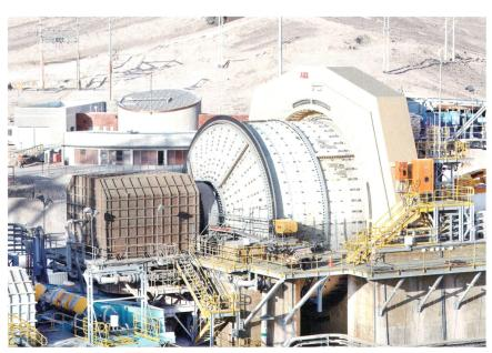
Un broyeur à minerai sans engrenage d'ABB: le CSEM utilise une telle installation dans le cadre d'un partenariat de recherche pour tester et développer sa solution de maintenance prédictive. Les algorithmes peuvent aussi être adaptés pour de petits systèmes.
