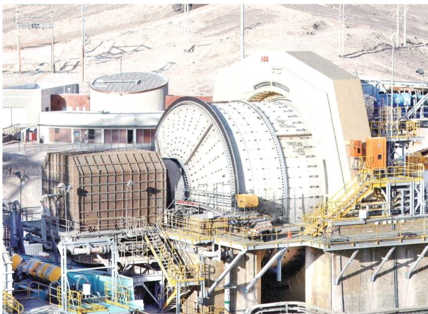
Eine getriebelose Erzmühle von ABB: Anhand einer solchen Anlage testet das CSEM im Rahmen einer Forschungszusammenarbeit die Predictive-Maintenance-Lösung und entwickelt sie weiter. Die Algorithmen lassen sich auch auf kleine Systeme übertragen.
