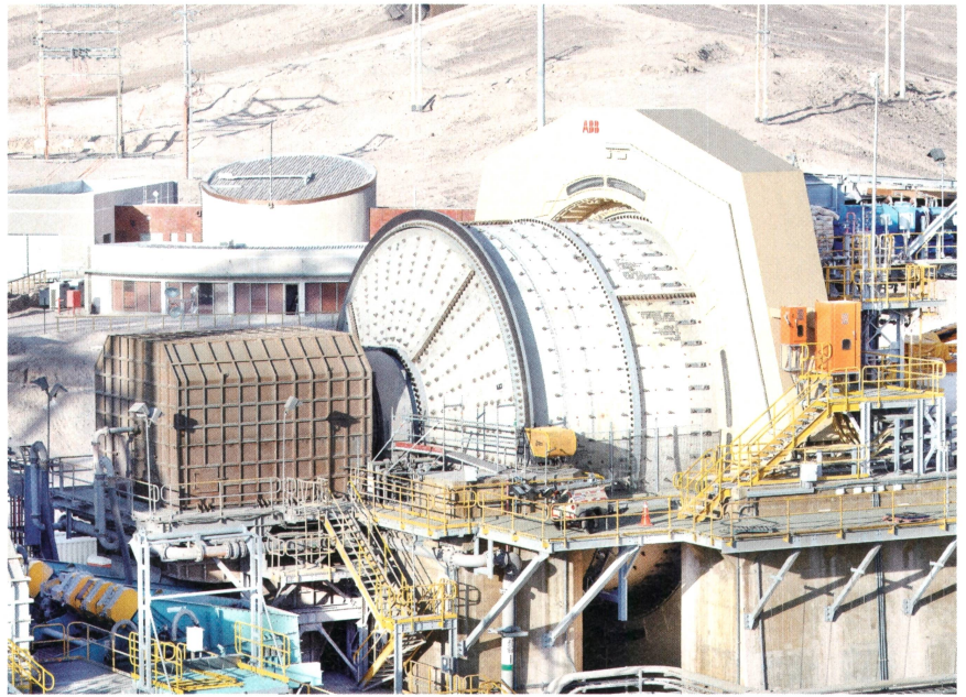
Eine getriebelose Erzmühle von ABB: Anhand einer solchen Anlage testet das CSEM im Rahmen einer Forschungszusammenarbeit die Predictive-Maintenance-Lösung und entwickelt sie weiter. Die Algorithmen lassen sich auch auf kleine Systeme übertragen.
