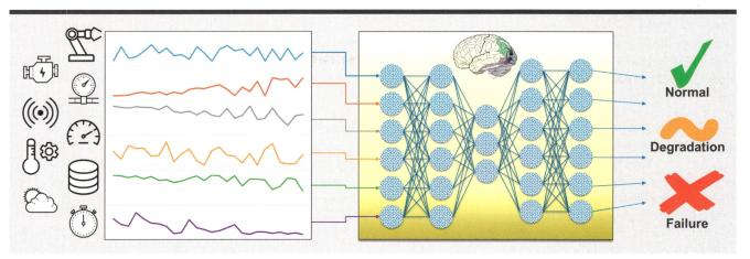
Daten einer Maschine werden in einem neuronalen Netzwerk verarbeitet, das aus vielen mathematischen Funktionen besteht. Das künstliche Gehirn erkennt selbstständig, ob sich ein Defekt anbahnt.
