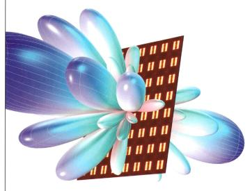
Elektrisches Fernfeld einer Anordnung schlitzgekoppelter Microstrip-Patch-Antennen.
