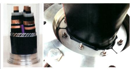
**Bild 2** Kabelmuster und detaillierte Ansicht des Kunststoffaussenmantels mit 129 mm Durchmesser und mit Abdichtungsvorrichtung beim Muffenschachteingang.
