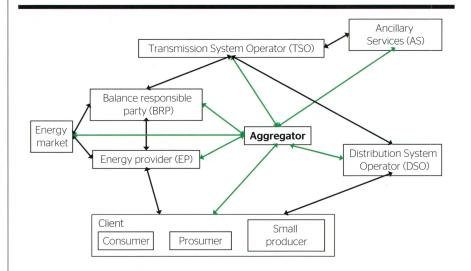
Figure 1 Acteurs de la flexibilité du réseau électrique.
