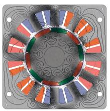
**Bild 4** Feldliniendarstellung des 10-poligen Funktionsmusters im Bemessungspunkt.
