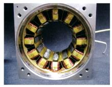
**Bild 6** Drehfeldständer des 10-poligen Funktionsmusters.
