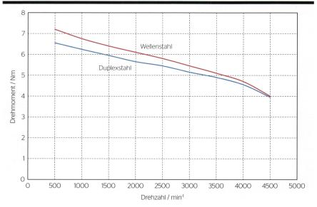
**Bild 9** M(n)-Kennlinien für den S1-Betrieb (100 K) bei Ausführung des Läufers mit Duplexstahl bzw. mit üblichem Wellenstahl.
