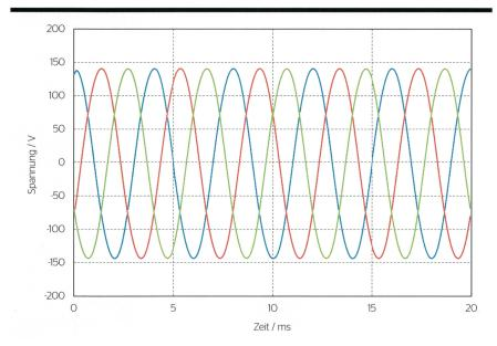
Bild 7 Gemessener zeitlicher Verlauf der induzierten Strangspannungen bei 3000 min<sup>-1</sup>.
