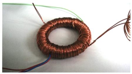
Bild 1 Ringprobe für die Bestimmung der magnetischen Eigenschaften.
