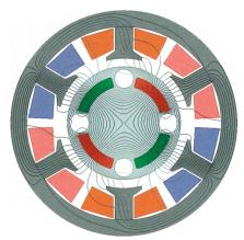
**Bild 5** Feldliniendarstellung des 4-poligen Funktionsmusters im Bemessungspunkt.
