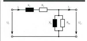
**Bild 1** Ersatzschaltung eines Transformators.
