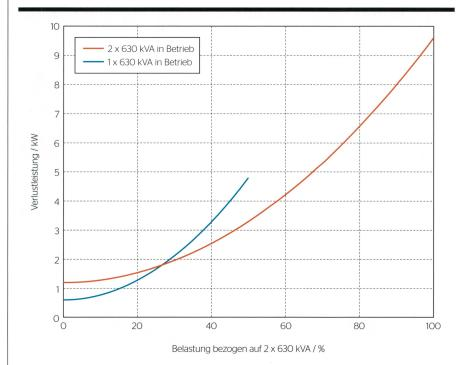
Bild 2 Typische Verlustkurven einer Transformatorstation.
