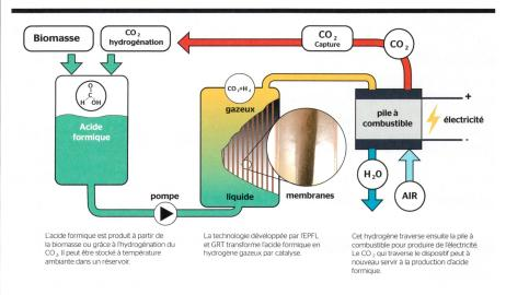
Utiliser l'acide formique comme réserve d'hydrogène. Diagramme qui illustre le principe de l'Hyform.
