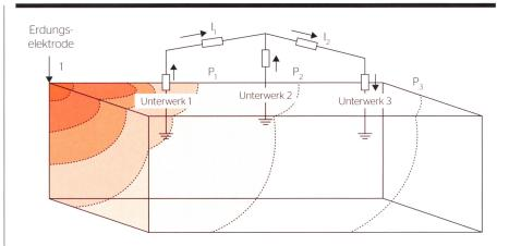
**Bild 1** Prinzipiell mögliche Einstreumöglichkeiten von Gleichströmen im Netz.[1]
