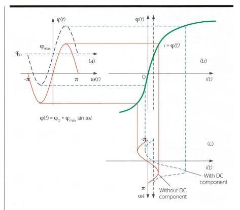
Bild 3 Transformatorsättigung beim Vorhandensein von Gleichströmen.[1]
