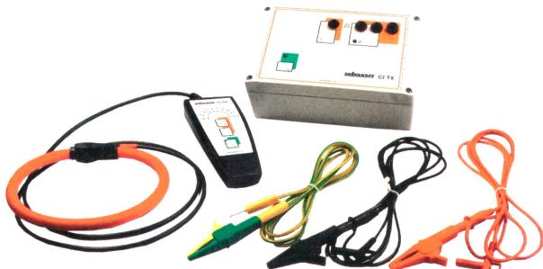
Das Kabelauslesegerät CI/LCI von SebaKMT besticht durch seine einfache Bedienung. Für die Auslese an freigeschalteten Kabeln dient ein aktiv sendernder Auslesegenerator der Impulse bis 100 A erzeugt. Einspeisung galvanisch oder mittels Sendezange. Signalempfang mit Flexwandler oder Drallfeldsensor. Das Gerät wird in einem Koffer als komplettes Set geliefert.
