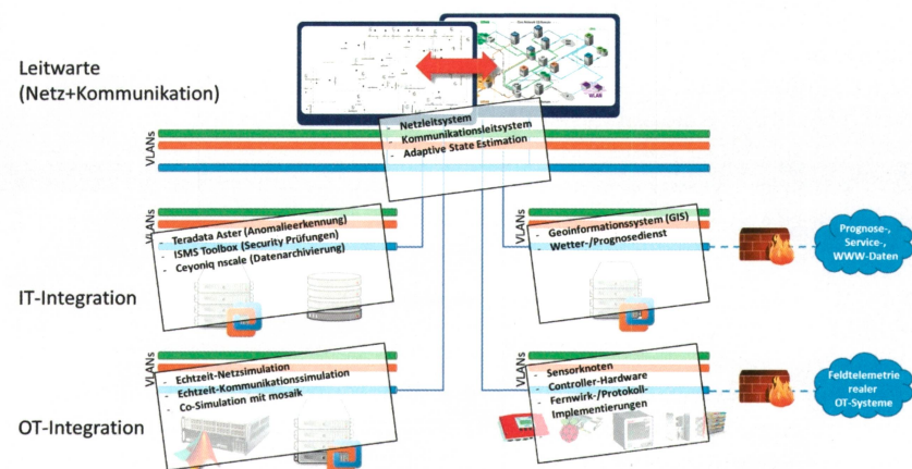
Bild 3 Schematischer Laboraufbau zur Abbildung der unterschiedlichen Schichten eines typischen Energieversorgungssystems.
