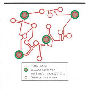
**Bild 2** Ausschnitt Axpo-Verteilnetz mit Stützpunkt- und Versorgungsunterwerken.
