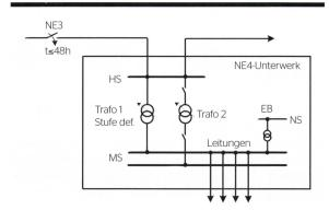
**Bild 3** Prinzipschema Ausgangszustand im Versorgungsunterwerk.
