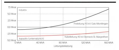
Bild 4 Blindleistungsverhalten einer Frei- und einer Kabelleitung.
