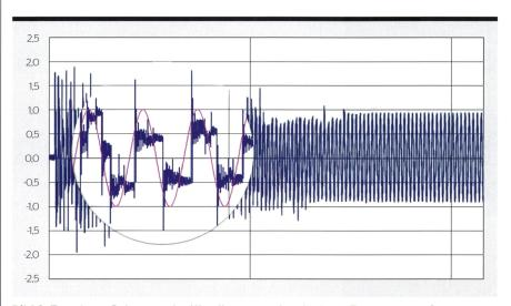
Bild 2 Transiente Belastung der Wandler, wenn sie mit einem Trenner unter Spannung gesetzt werden.
